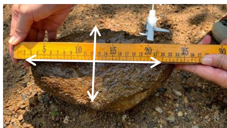
↓ 圖 3 用米尺測量推移質大小
