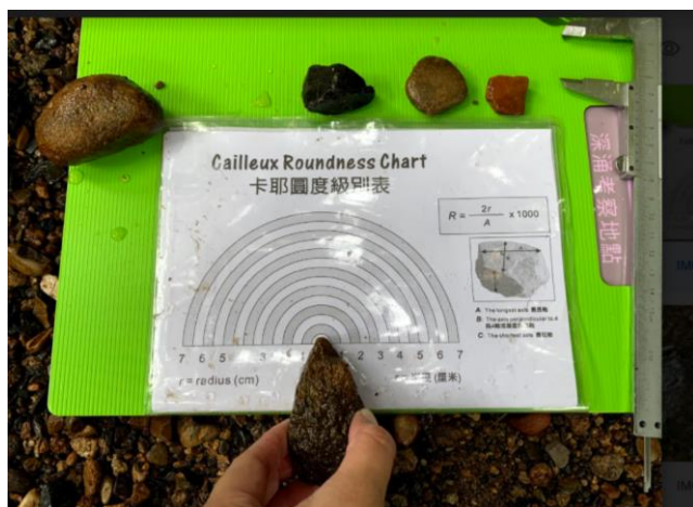
↓ 圖 7 通過卡耶圓度級別表評估最尖角的半徑
